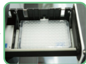
抽出液を別のプレートに採取し、タンデムマスにセットします。
