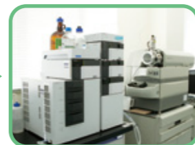
タンデムマス(タンデム型質量分析計) 分子量の測定によって、多種の物質の検出と定量を行います。
