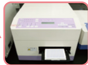
蛍光プレートリーダー ガラクトース検査では蛍光の強さでガラクトースの量を測定します。
