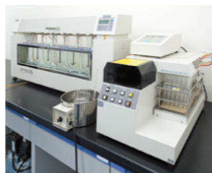
溶出試験器 固形製剤の規定時間における溶出率を測定します
