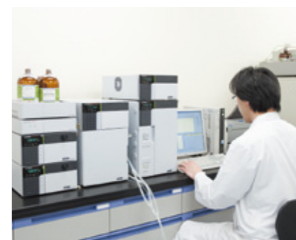
液体クロマトグラフ 固形製剤の含有成分を分析します
