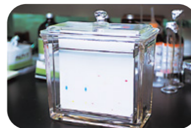
薄層クロマトグラフによる 酸性タール色素の測定
